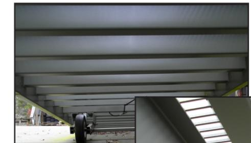
La estructura consta de largueros laterales de acero formado para servicio pesado, completamente soldados en vigas de acero de alta resistencia. (La imagen muestra el lado inferior de la rampa.)
